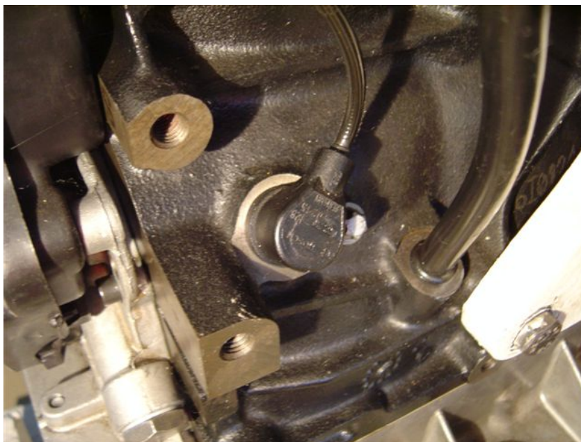
Sensor de rotación en el block con rueda fónica interna
